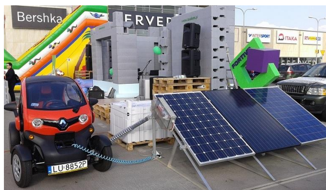
Rys. 6. Ładowanie pojazdu elektrycznego z fotowoltaicznych ogniw słonecznych
