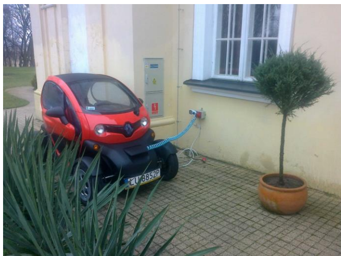
Rys. 3. Ładowanie pojazdu elektrycznego z zewnętrznego gniazdka elektrycznego
